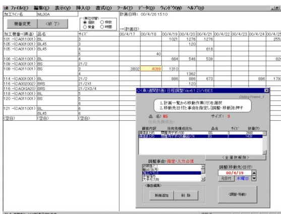
図3：ASPROVAの計画結果を各担当者が確認、修正できるような機能をEXCELで自社開発した。ここで修正した結果は最終的にCOMを通してASPROVAに送信される。
