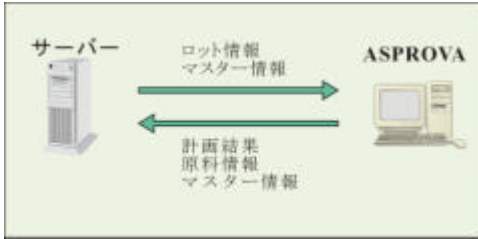
図1：システム概要図。計画立案に必要なロット、マスターデータがサーバーから送信される。クライアントからは計画結果としてジョブデータや原料の情報が送信される。また、クライアント側で登録されたマスターデータも送信される。原料の情報については、ASPROVAの原料テーブルをADSPCSV機能を利用して必要なフィールドのみを出力するように設定してある。
