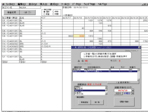
図3：ASPROVAの計画結果を各担当者が確認、修正できるような機能をEXCELで自社開発した。ここで修正した結果は最終的にCOMを通してASPROVAに送信される。
