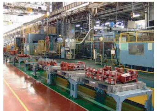
2基、と「5面加工機」1基より構成されている。加工ワークが極めて大きいので、加工ワークを固定した状態でフライス加工、エンドミル加工、穴あけ加工、タップ加工といった4タイプの加工処理が施されることになる。固定した状態で加工を行うため、ワークの取り付け面は加工できないので、始めの加工が終わった段階で、部品を裏返しにして次工程の加工を行なうのだ。
