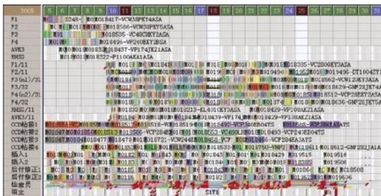
中間在庫(ボトルネック工程)にTOCの理論を適用、在庫を最少にし、前後工程をスケジュール
